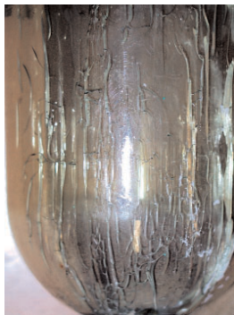
Haarrisse entstehen z.B. durch chemische Reinigungsmittel
