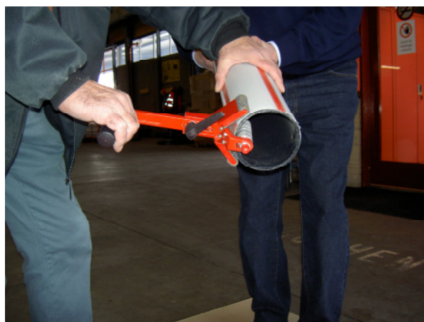
Bild 11: Anschrägen mit Anfasgerät
